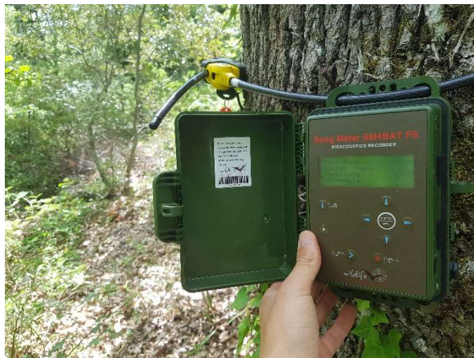
Figure 9. Paramétrage d'un SM4BAT © J. COSTA | CEN PACA
